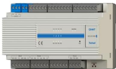
采集器是专门针对国家机关办公建筑和大型公共建筑以及节约型园区节能监管体系建设的市场需求而设计的一款水、电、气、冷、热量一体化能耗数据采集器。SMC-GW-M2002采集器具备1个以太网上传接口、大容量存储介质、2个RS485总线接口、2个MBUS总线接口、1个RS232接口等，还支持协议自定义等功能，以实现针对基于RS485及MBSU现场总线的各种不同通信协议设备的数据采集、历史存储、远程传输，并具备一定的数据分析处理、故障定位和报警等功能。
