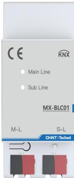
MX-BLC01线路耦合器是一款集 KNX 线路耦合器和 KNX 线路中继器功能于一体的模块化安装设备，它被作为线路耦合器时，连接主线和干线或区域线路。作为一个线路中继器，它可以使一条总线上连接多于64个设备。用这种方式提供电气隔离。通常耦合器只承认它途径的报文。参数报文确认参数在两条线路单独确认设置。
