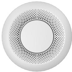
SICDP20 是空气环境传感器产品之一，广泛应用于建筑智能楼宇工程中室内空气质量的 CO2 浓度的实时监测，采用进口数字传感器，克服传统模拟式传感器不稳定、误差大、易受干扰、需定期校准等严重缺陷。同时具有采集精确可靠、外形小巧美观、防浪涌电压、无极性供电通讯等优点，广泛应用于商业办公、地铁、医院、图书馆等建筑环境控制场合。
