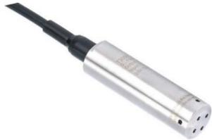
该产品由高性能压力传感器作为测量元件，通过压力传感器，把与液位深度成正比的液体静压力准确测量出来，并经过专门信号调理电路转换成标准（电流或电压）信号输出，建立起输出信号与液体深度的线性对应关系，实现对液体深度的精确测量。产品精度高、体积小、使用方便，直接投入液体中，即可测量出变送器末端到液面的液位高度。适用于石油、化工、电厂、城市供水、水文勘探领域的水位或液位测量与控制。
