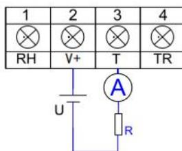
接线端子可用0.75mm<sup>2</sup>~1mm<sup>2</sup>铜质软导线压接至接线鼻子, 再将接线鼻子接入到传感器接线端子, 建议用屏蔽电缆以预防干扰, 屏蔽层应在控制器一侧接入大地。
