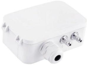
本产品适用于暖通空调（HVAC）、能源管理系统、VAV及风扇控制、环境污染控制静态管路和洁净室压力、烟雾罩控制、烘箱增压及炉通风控制等领域。压力传感器检测差压或表压压力，并把此压差转换为成比例的电信号输出。用于楼宇能源管理系统，这种传感器能够测量楼宇增压和空气流动控制所需要的精确压力和流量。采用进口压力芯体，具有压力反应灵敏、长期输出稳定、温度性能优越等特点。
