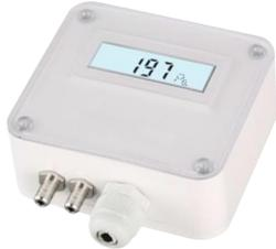
此款压差传感器是检测差压或表压压力，并把这个压力值转换为成比例的电信号输出,用于智能楼宇能源管理系统，起到测量楼宇增压和空气流动控制所需的精确压力和流量。广泛用于空气或中性气体的监测，多种压力单位、量程可切换。采用进口微压芯体，数字型压力采集及温度补偿方式具有压力反应灵敏，长期稳定输出，温度性能优越等特性。
