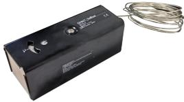
STCL3低温断路器工作于单刀双掷模式。主要应用:低温条件下用于保护热交换器、表冷器以及液体工作管路为避免过冷或结冰。该控制器结构紧凑、性能可靠,并且具有回差固定的可调温度设定点。
