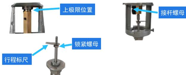
2. 将驱动器接杆螺母手动旋入至阀杆极限位置, 并保证驱动器立筋在行程标尺的凹槽部分;
