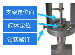
4. ①用工具将接杆螺母和锁紧螺母相互紧固(10mm 和 14mm 扳手)。
