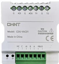
**CDU-VAC01**是一款我公司自主研发的PBUS总线分布式单元模块，具有1路模拟量输出、3路模拟量输入、1路RS485接口、1路PBUS总线接口，可用来控制模拟量设备及采集模拟量数据；产品内置调节阀控制逻辑，可按百分比调节控制输出，产品外观简单小巧，方便产品安装与接线。
