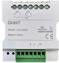
**CDU-MS01**是一款专门用于监视RS485总线数据的模块，可以用来监视串口是否有收发数据，从而判定受监控设备是否出现故障。产品内部自带判定逻辑，可通过通讯协议设置超时时间，模块串口在超过超时时间未收到数据后，会使受监控设备断电重启，从而规避一些设备故障问题。产品外观简单小巧，方便产品安装与接线。
