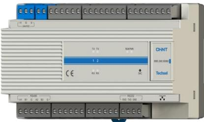
采集器是专门针对国家机关办公建筑和大型公共建筑以及节约型校园节能监管体系建设的市场需求而设计的一款集水、电、气、冷、热量一体化能耗数据采集器。SMC-GW-E2002采集器具备1个以太网上传接口、大容量存储介质、2个RS485接口、1个RS232接口，还支持协议自定义等功能，以实现针对基于RS485总线的各种不同通信协议设备的数据采集、历史存储、远程传输，并具备一定的数据分析处理、故障定位和报警等功能。
