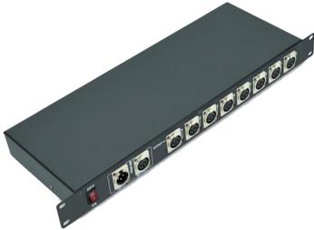
数码信号分配器专用于对 DMX512 数码灯光控制信号进行整形放大，输入输出接口采用高压隔离技术，适用于 DMX512 信号经远距离传输衰减后的整形放大处理，以及各分配输出接口之间、输入接口与各分配输出接口之间需要完全电气隔离的使用场合。由于各个接口之间互相独立隔离，因此可以避免因控制线路、电脑灯、硅箱等问题而烧毁精密的数码灯光控制台，确保数码灯光控制台的安全运行，同时也保证 DMX 信号能正常传送至各种灯光设备，从而提高整个数码灯光控制系统的可靠性。
