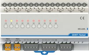
MO-LC08是SMC系列开关量模块产品之一，广泛应用于智能照明、安防报警等机电设备控制领域，具有8路开关量输入、8路继电器输出功能；开关量输入可接入开关、报警、红外人体感应器等信号，继电器输出可控制照明、电机、报警等开关回路。
