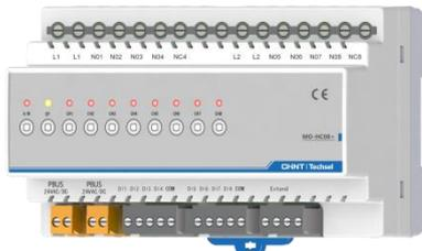
MO-HC08/MO-HC08+是SMC系列开关量模块产品之一，广泛应用于智能照明、安防报警等机电设备控制领域，具有8路开关量输入、8路继电器输出功能；开关量输入可接入开关、报警、红外人体感应器等信号，继电器输出可控制照明、电机、报警等开关回路。
